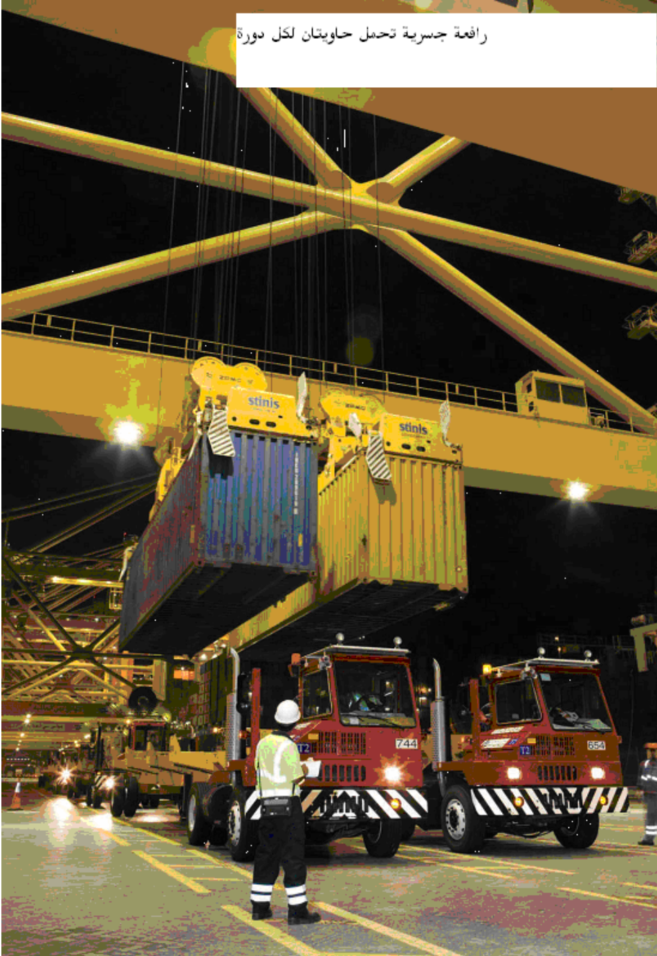
رافعة جسرية تحمل (2) حاوية لكل دورة وهي أكثر تطوراً وإنتاجية.
