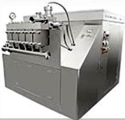
صورة ( 2- 7 ) توضع جهازالتجانس
