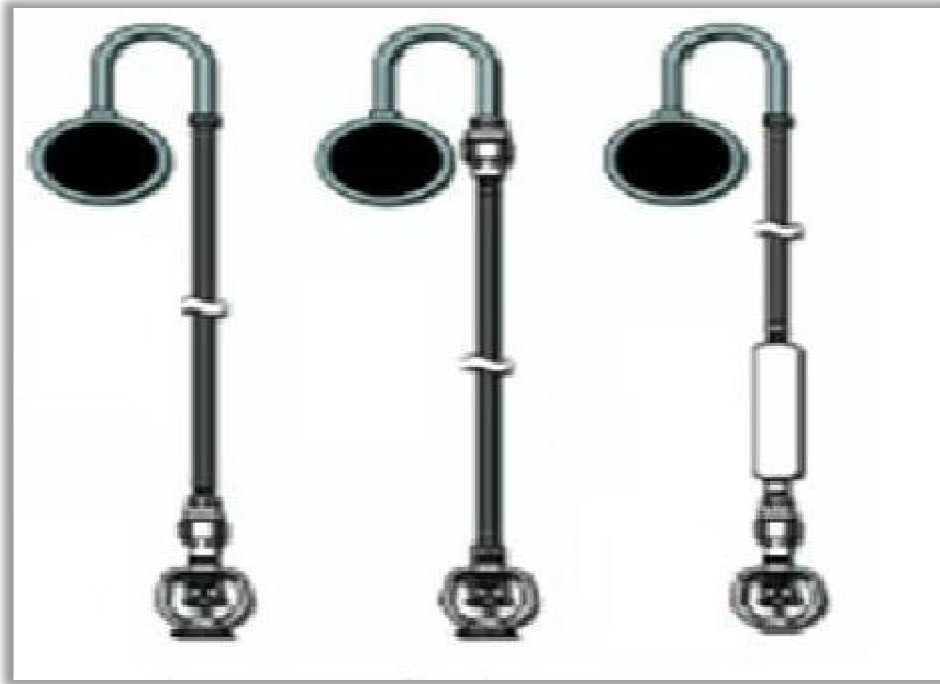
الشكل (2-15) الأنابيب الهابطة لإضافة المياه
