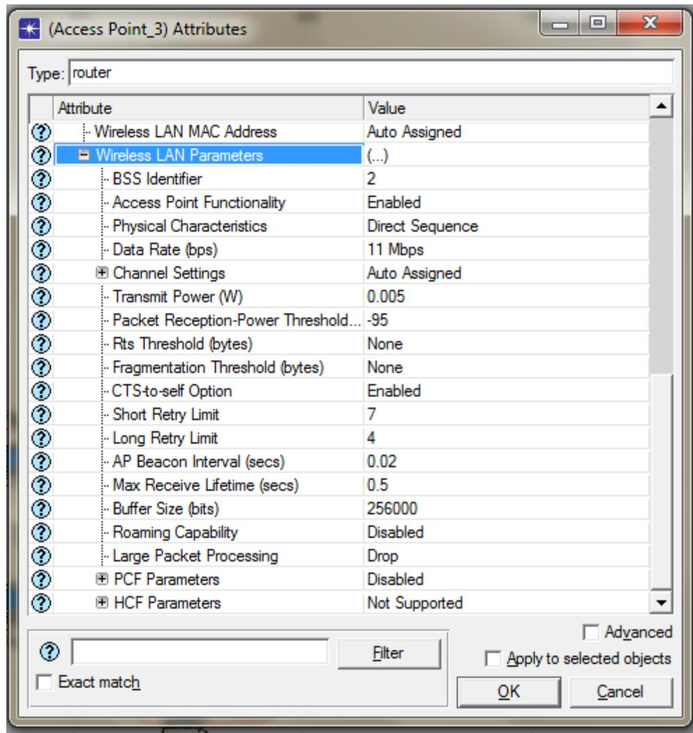
Figure 3-5 : Access point parameters
