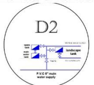
التغذية بتجميع ضغط الشبكة و ضغط الخزان و الرفع بطلمبات للخزان العالي من خزان أرضي و تغذية الأدوار المنخفضة بضغط الشبكة
