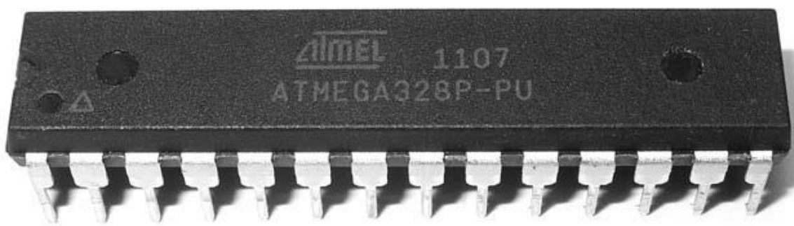
Fig 2.39. An Arduino Uno Microcontroller
