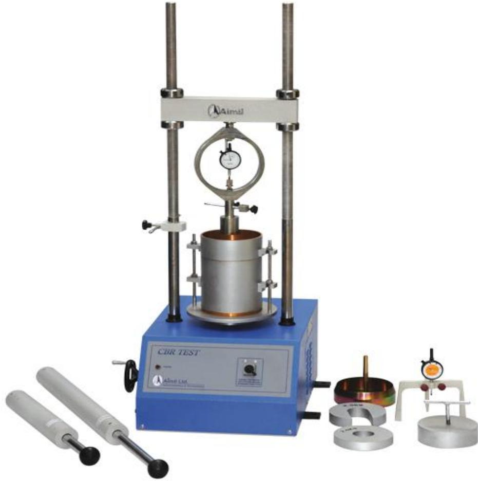
شكل (4-9) يوضح جهاز التحميل
