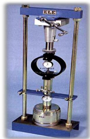
شكل (4.5) صورة جهاز التحميل CBR
