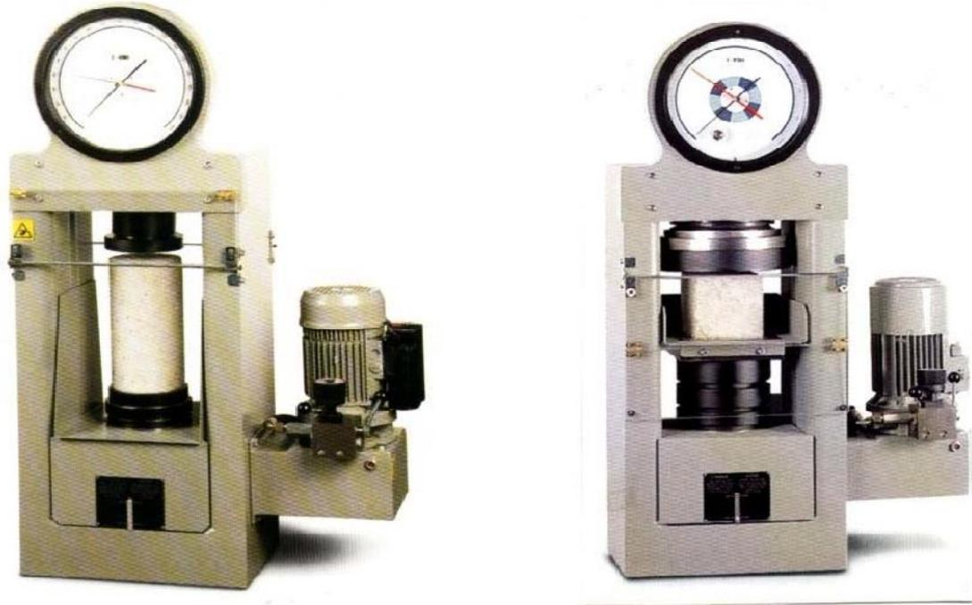
شكل (1) يوضح ماكينة قياس مقاومة المكعبات الخرسانية
