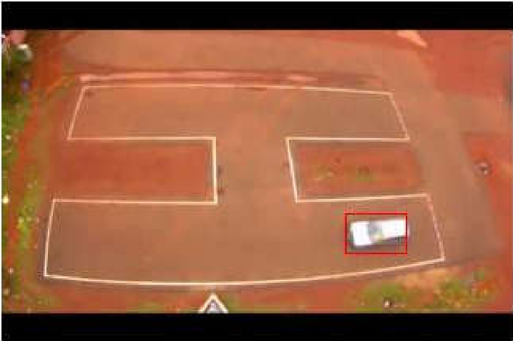
شكل رقم (20) تحديد الصندوق الذي يحيط بالعربه في الصورة الاصلية قبل المعالجه
