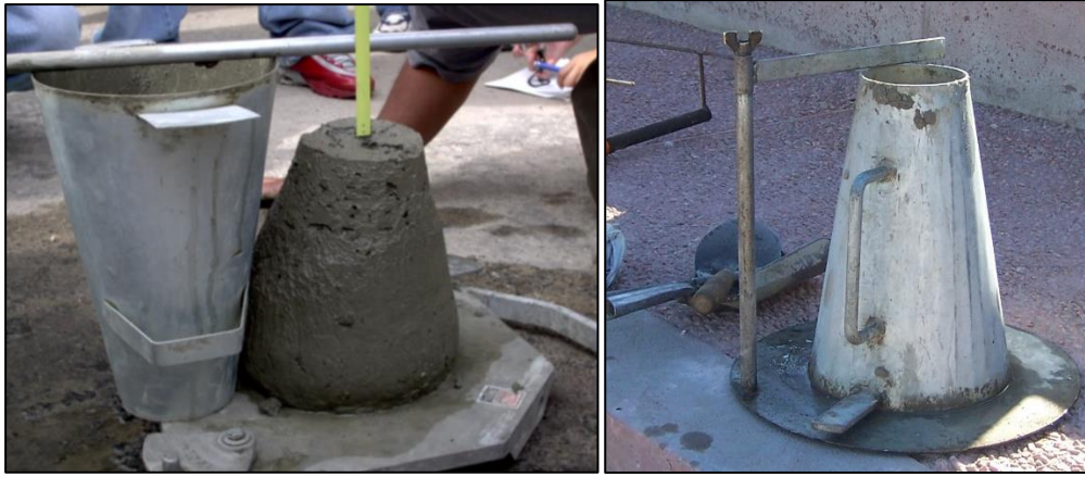
الشكل (4.2) : يوضح إختبار الهبوط
