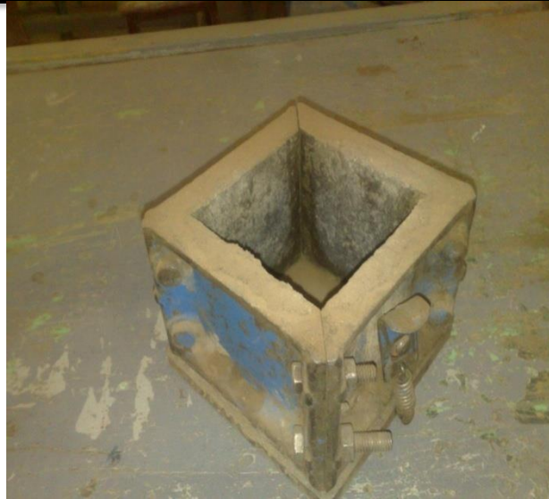
شكل رقم (3.3): يوضح قالب صب العينة
