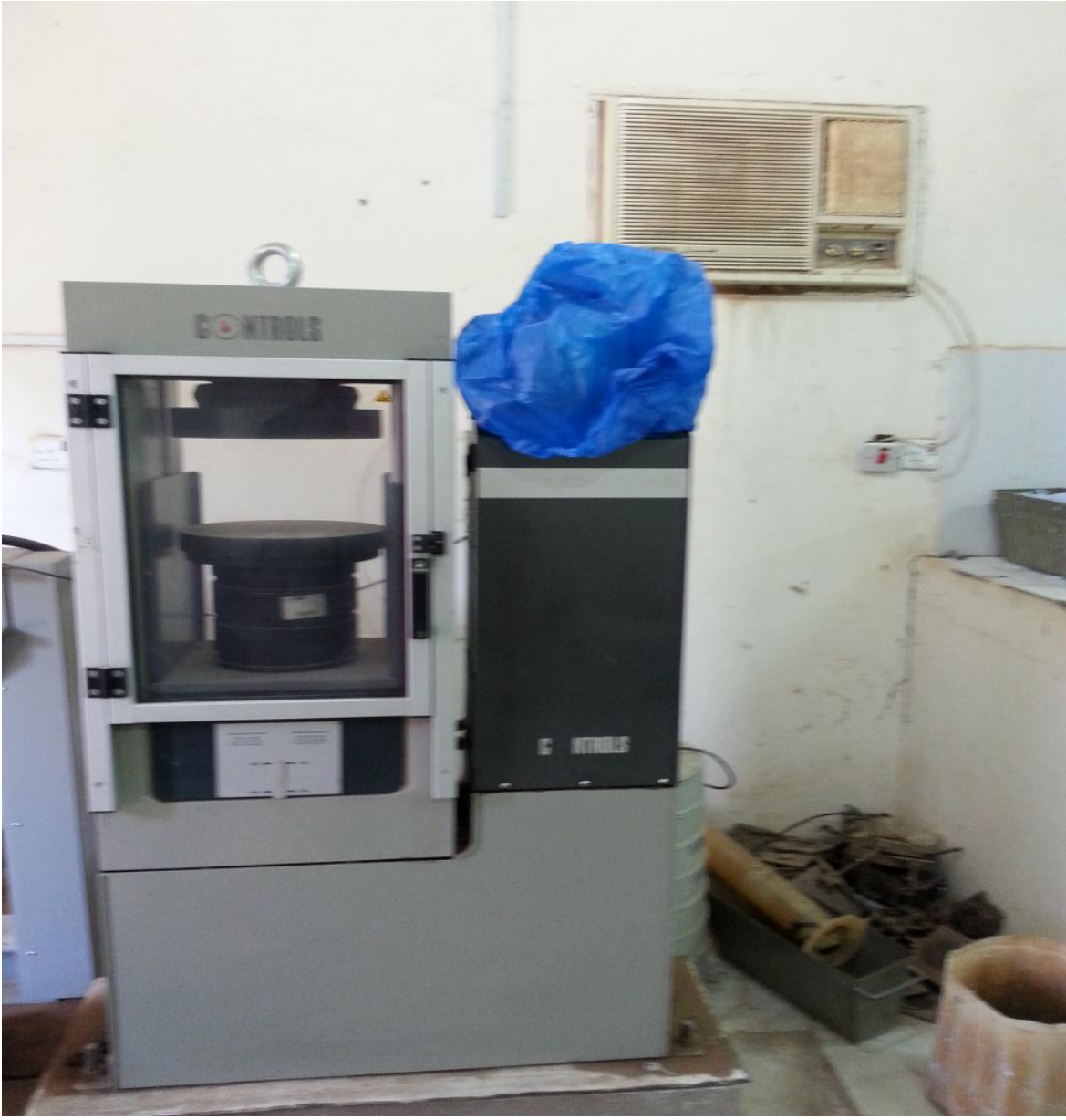
الصورة (أ.7) : توضيح ماكينة كسر المكعبات
