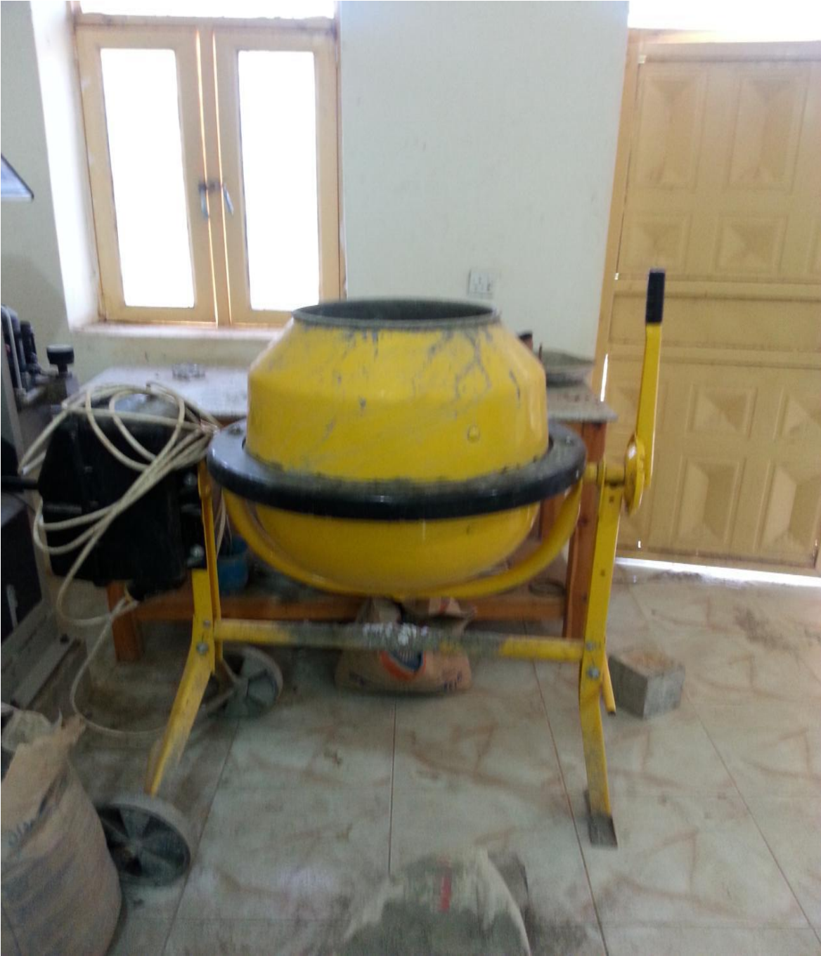
الصورة (أ.4): توضيح الخلاط المستخدم في خلط المواد
