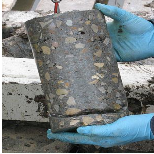
الشكل (2.6): عينة القلب الخرساني
