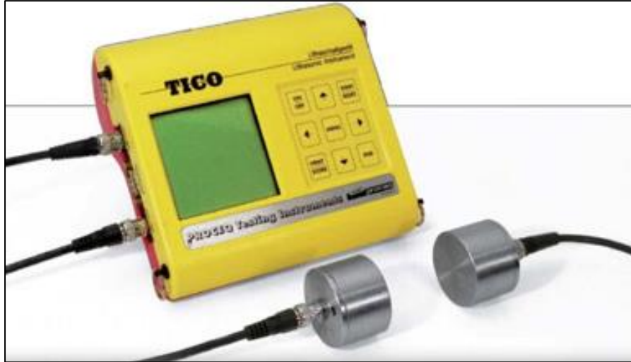
الشكل (2.10): جهاز قياس سرعة الموجات الصوتية
