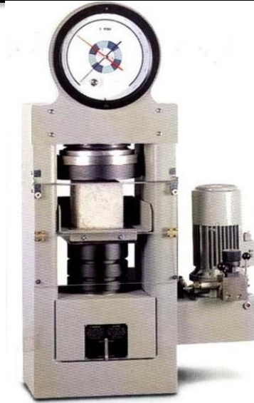
الشكل (2.3): يوضح الجهاز المستخدم لكسر العينة
