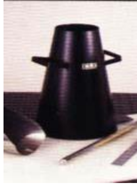
الشكل (3.2): يوضح قالب إختبار الهبوط
