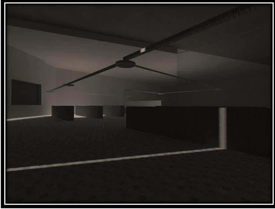
صورة 5-39 منظور داخلي ليوضح شبكة الرشاشات بغرفة الارشيف والمستندات بالمبنى الاداري تم استخدام رشاشات من الغاز (ثاني اكسيد الكربون).
