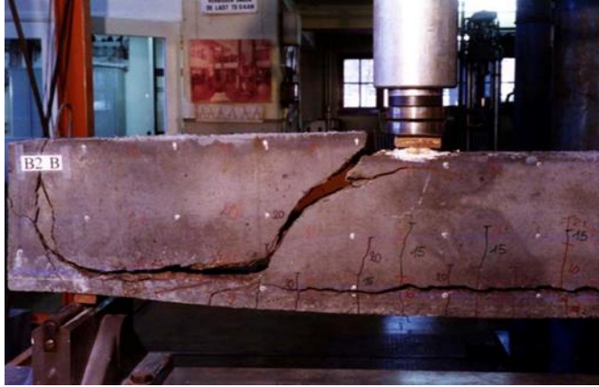
الشكل (2-4-5) انهيار قص (شد قطري) في كمرة من الخرسانة المسلحة بدون كانات (امام، 2002)
