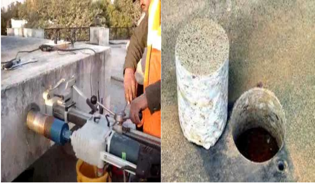
الشكل ( 21 -4-2 ) جهاز ماكينة الثقب (القلب) مع شكل العينة المستخرجة
