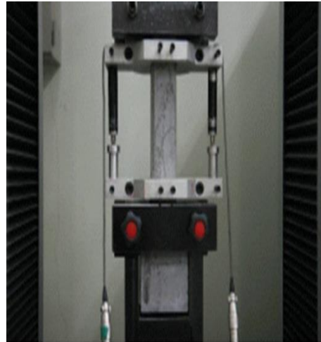
الشكل (2-4-2) الية اختبار الشد المباشر
