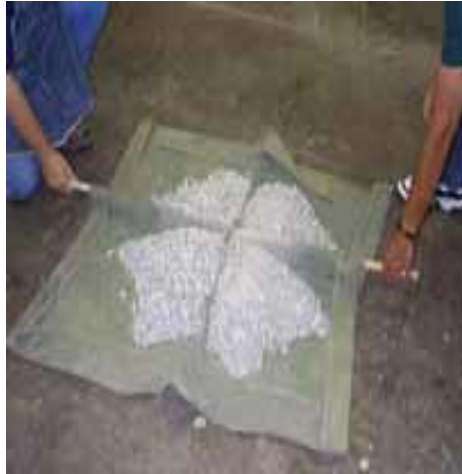
الشكل ( 2-2-5 ) طريقة التقسيم الرباعي لتحضير عينة اختبار الركام
