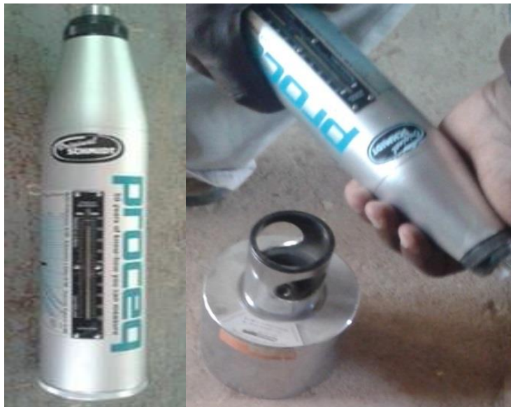
الشكل (3-8) جهاز مطرقة شميدت وسندان المعايرة
