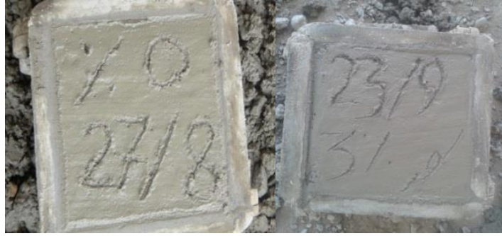
الشكل (3-3) نماذج المكعبات حسب نوع الخلطة
