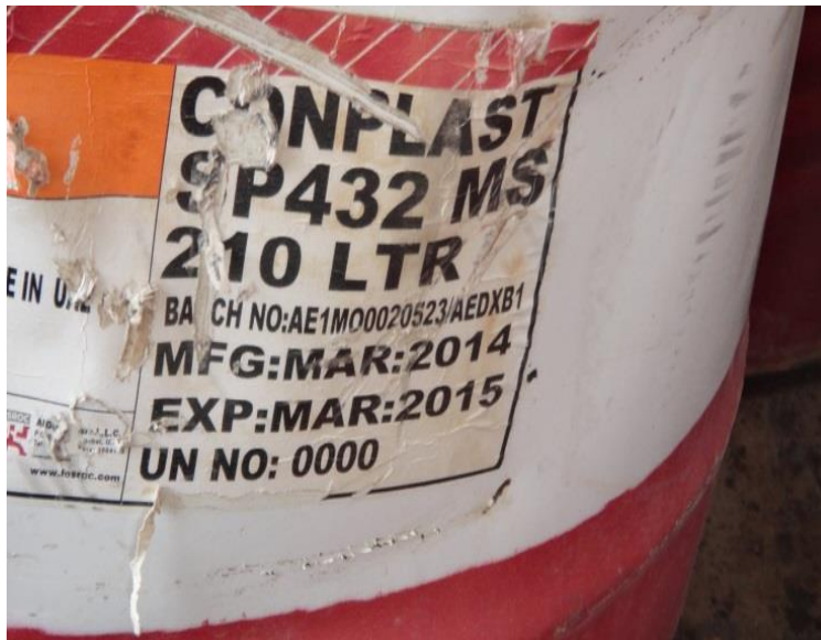
الشكل (3-2) صلاحية استعمال المضاف الملدن المتفوق SP
