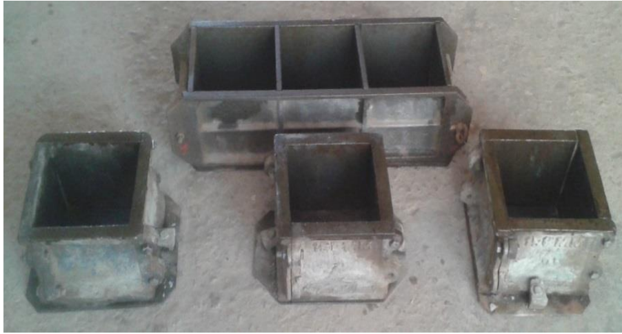
الشكل (3-4) اشكال نماذج قوالب المكعبات المستعملة
