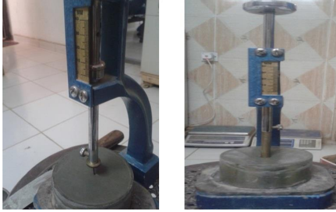
الشكل ( 3-5 ) جهاز فيكات في اختبار تحديد القوام و زمن الشك للأسمنت
