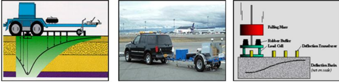
الشكل رقم (2-6) تشغيل ومبادئ الحمل الساقط الثقيل ( HWD )
