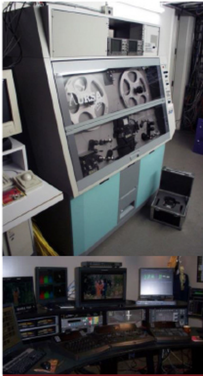
صورة ٣-١٨ : جهاز التيليسينما
