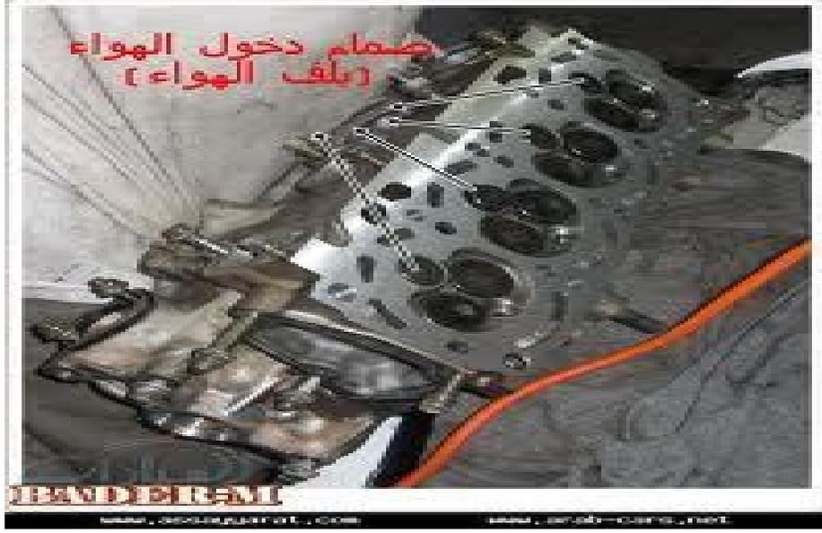
الشكل ( 2-6 ) يوضح صمام دخول الهواء .
