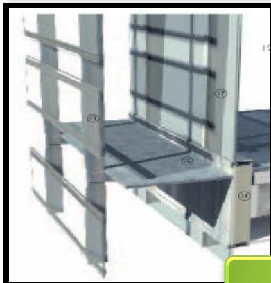
تفصيلة لتكسية الزجاج شكل رقم 11-5
