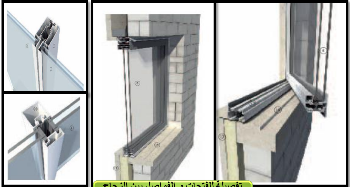
تفصيلة للفتحات و الفواصل بين الزجاج شكل رقم 12-5
