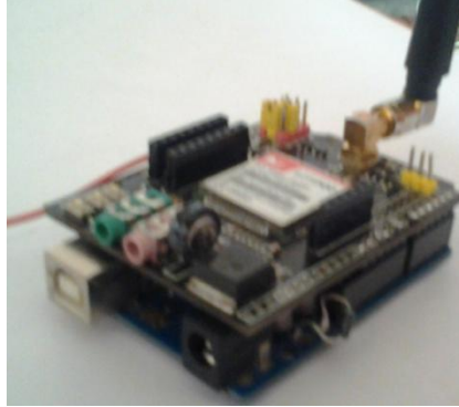
الشكل (5.5) تركيب غطاء (GSM) على لوحة الأردوينو
