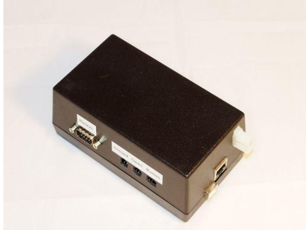
الشكل (1.2) مشروع متحكم باب باستخدام أردوينو و ساعة وقت حقيقي
