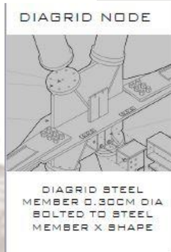
شكل (7-5) يوضح عقدة نظام ال DIAGRID وربطة الزجاج به
