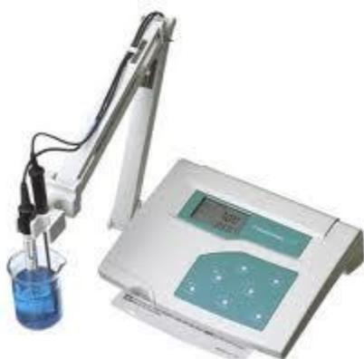
جهاز قياس الرقم الهيدروجيني (PH)
