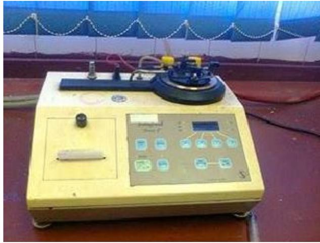
ملحق رقم (2) جهاز قياس درجة حرارة الوميض
