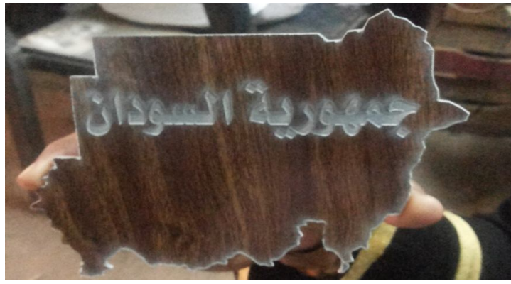
الشكل رقم(14) يوضح قطع و نحت الخشب بالليزر
