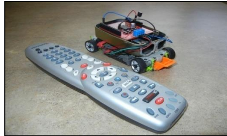
الشكل (11.2) التحكم في سيارة العاب بإستخدام ريموت التلفاز و الاردوينو
