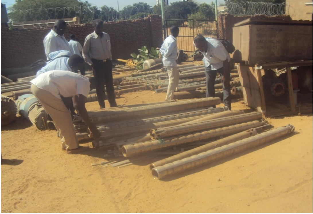
ملحق (7): فحص المضخات الغاطسة بمنطقة شقرة
