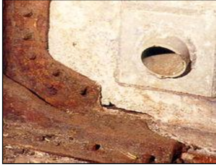
الشكل 9.2: التآكل الجلفاني للحديد والألمونيوم في وجود ماء مالح
