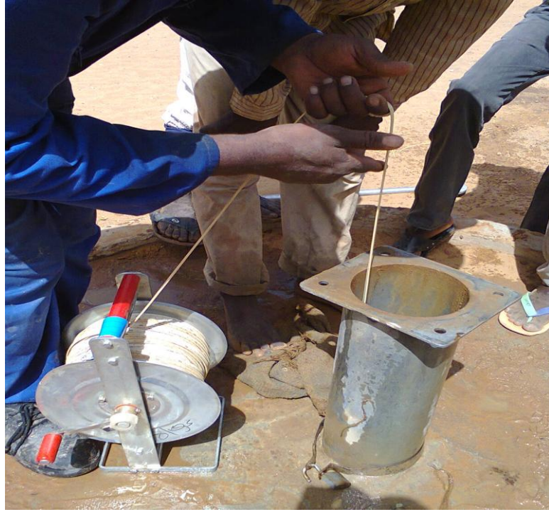
ملحق (12): جهاز (Hair Meter) لقياس مستوي الماء يدوياً بمدينة الفاشر
