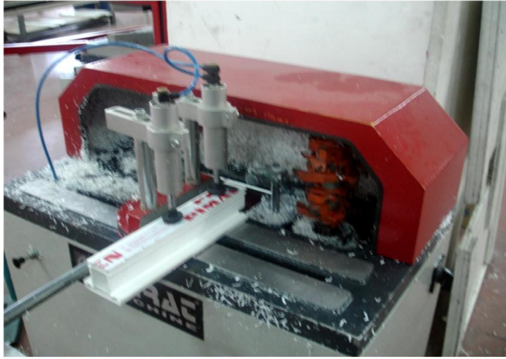
ماكينات تفريز الالمونيوم تعمل بإدخال المعلومات بواسطة الحاسوب
