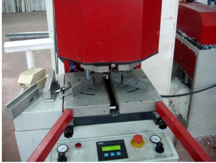
ماكينة جميع الزاوية للالونيوم تعمل بإدخال المعلومات بواسطة الحاسوب
