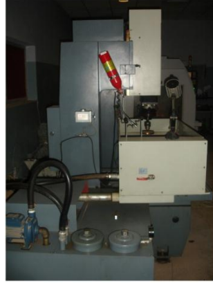
نوعان من الماكينات التي يتم بواسطتها الحفر علي المعادن بعد غمرها بالجازولين
