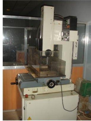
نوعان من الماكينات التي يتم بواسطتها الحفر علي المعادن بعد غمرها بالجازولين
