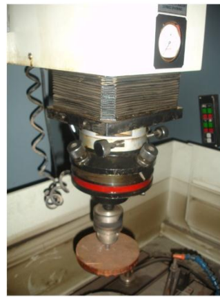
الماكينة التي يتم بواسطتها الحفر علي المعادن بعد غمرها بالجاولين ( حوض الغمر )
