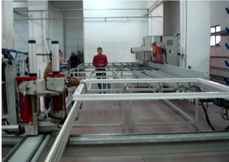
ماكينة جميع الالونيوم تعمل بإدخال المعلومات بواسطة الحاسوب
