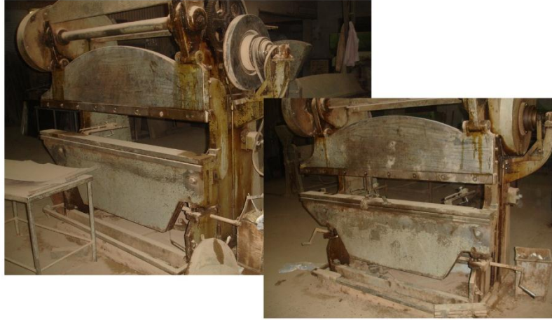
ماكينة التخرم اليدوية - تستخدم لفتحات المسامير والاربطة للصاج
