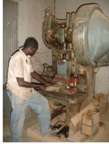
ماكينة الشطف اليدوية - تستخدم لتفريغ الصاج
