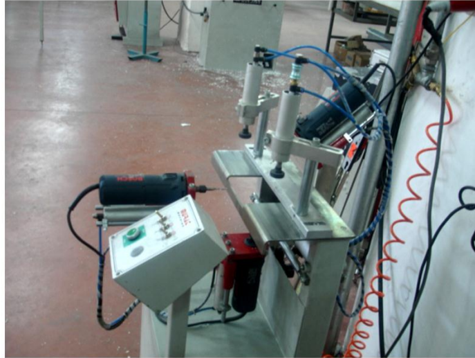
ماكينات حفر الالمونيوم تعمل بإدخال المعلومات بواسطة الحاسوب
