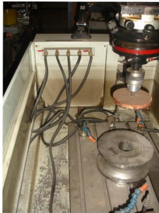
الماكينة التي يتم بواسطتها الحفر علي المعادن بعد غمرها بالجاولين ( حوض الغمر )
