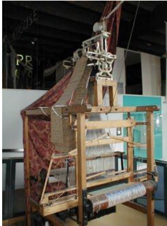
صورة رقم (16) توضح استخدام ماكينة جاكوا في تصنيع المنسوجات
