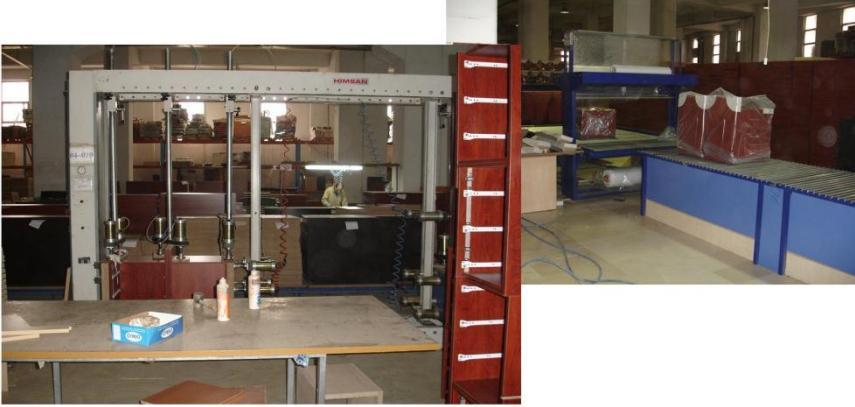
ماكينات التجميع للاخشاب تعمل بإدخال المعلومات بواسطة الحاسوب
