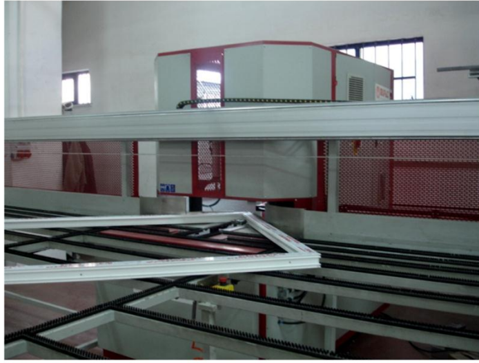
ماكينة جميع الالمنيوم تعمل بإدخال المعلومات بواسطة الحاسوب
