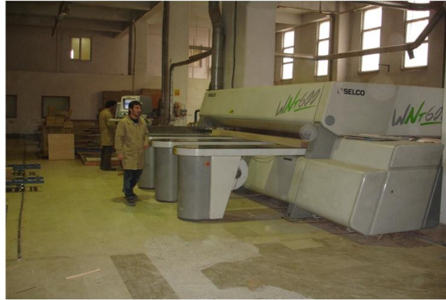
ماكينات توضع الاخشاب تعمل بإدخال المعلومات بواسطة الحاسوب
