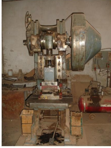
ماكينة الشطف اليدوية - تستخدم لتفريغ الصاج
