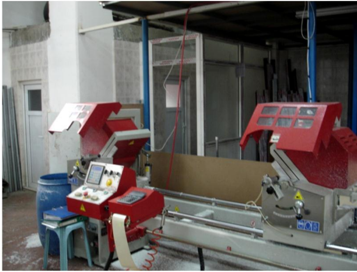
ماكينة توضع الالمنيوم تعمل بإدخال المعلومات بواسطة الحاسوب
