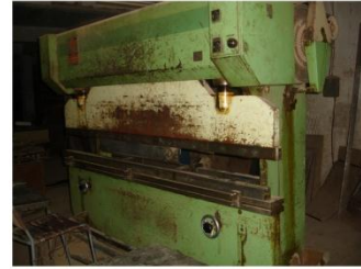
ماكينة التكميخ اليدوية - تستخدم لثني الصاج ( نصف يدوية )
