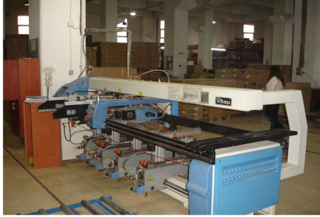
ماكينات تحريم الاخشاب تعمل بإدخال المعلومات بواسطة الحاسوب
