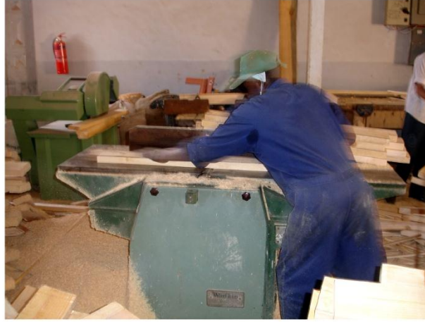
ماكينة منشار يدوية تستخدم لآعمال الخشب وتجهيزه
