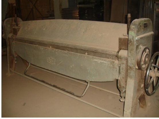
ماكينة التكميح اليدوية - تستخدم لثني الصاج ( يدوية بالكامل )
