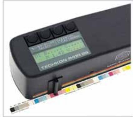
الشكل (٣-١-١٧) جهاز قياس الكثافة اليدوي لقياس الأهداف لشرائط الضبط الطباعي
