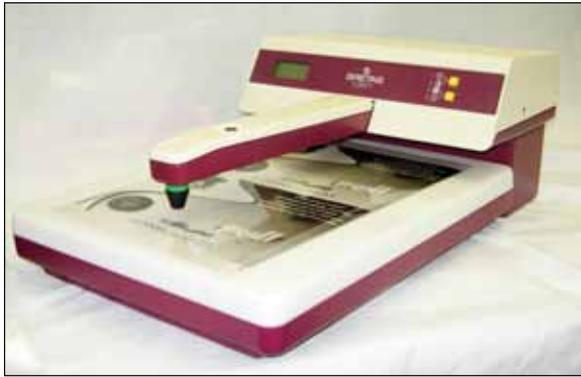
الشكل (٣-١-١٨) جهاز قياس الكثافة النافذة ويستخدم لقياس كثافة الأفلام
