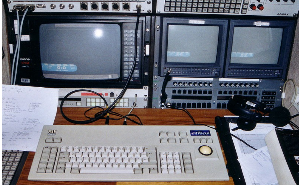
جهاز مولد الحروف للكتابة على الشاشة (Character generator) الشكل رقم (14)
