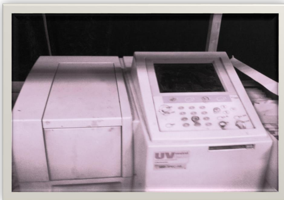
Fig (3.2): UV mini 1240 spectrometer shimadzu
