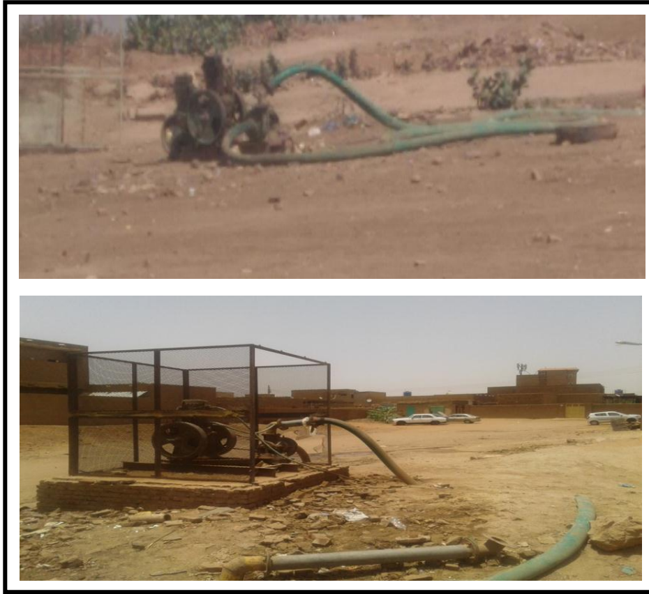
صورة رقم(5- 17): تظهر بعض الوابورات التي يتم بها سحب مياه الامطار
