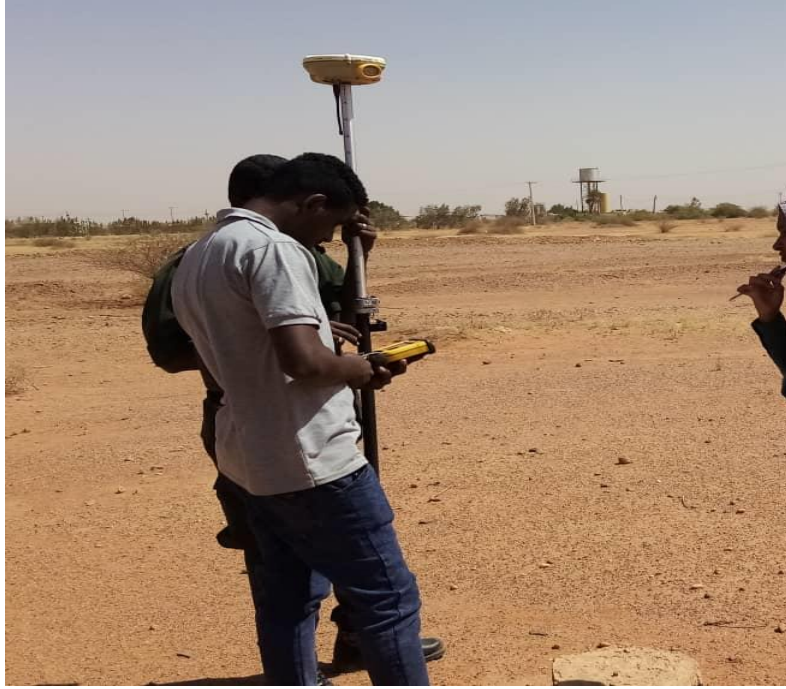
الشكل (4-15) أخذ القراءات وتسجيل الإحداثيات للنقاط
