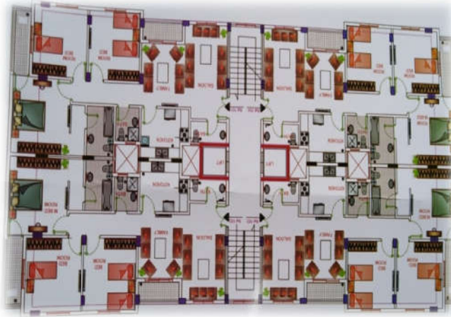
شكل (2-14): صورة توضح نموزج لتصميم الشقق الاكثر حداثة يوضح تجاور الحمامات مع المطابخ والتوصيلات دائما داخلية عند طريق المنافذ (duct)
