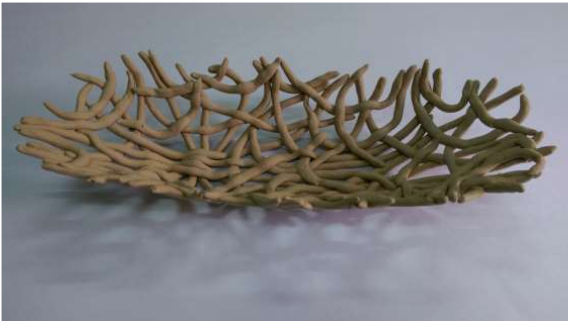
صورة رقم (18) نموذج لصحن من الخلطة رقم 5 بعد الحرق.
