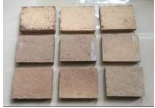
صورة رقم (9) نماذج لخلطات نفذت بالمكبس .
