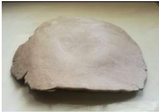
صورة رقم (17) فقدان نموذج لشكله بفعل الحرارة الزائدة .
