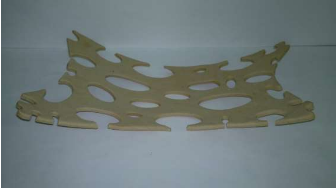
صورة رقم (17) نموذج لصحن من الخلطة رقم 9 بعد الحرق.
