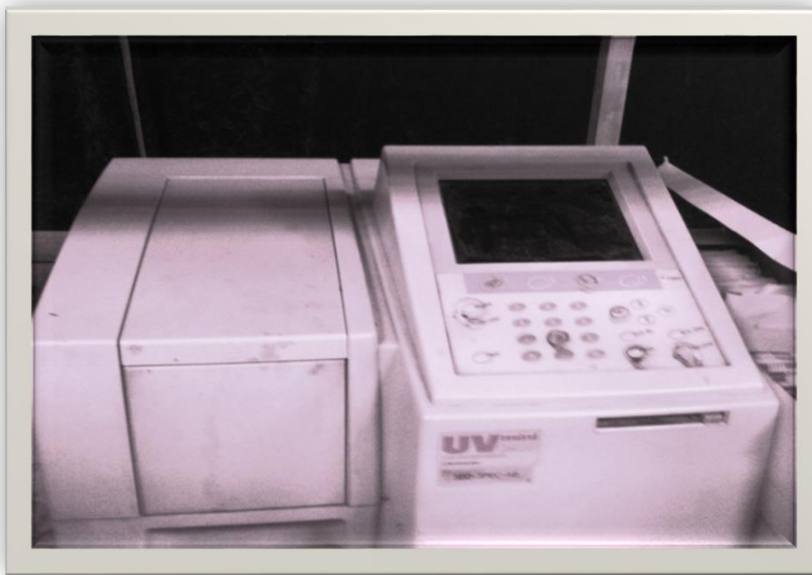
Figure (3.5): UV mini 1240 spectrometer shimadzu
