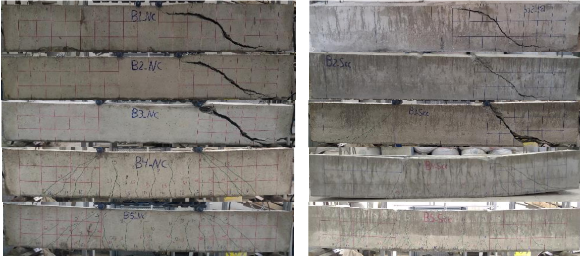
الشكل 5: الجوائز الخرسانية ذاتية الاكتنزاز (SCC) والعادية (NC) بعد إجراء التجارب عليها
