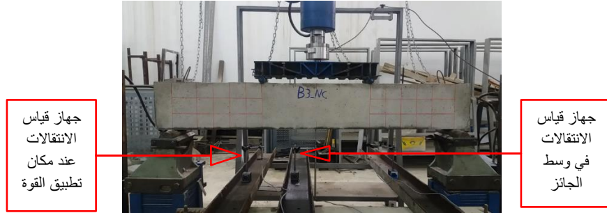
الشكل 3: الجانز وجهاز التحميل والمساند وأجهزة قياس الانتقالات
