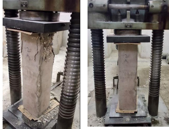
الشكل 6: اختبار عينة العمود على الضغط حتى الانهيار والشكل المتشوه
