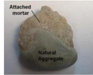
الشكل 1 : التحام المونة الاسمنتية مع حبيبات الحصى [2]
