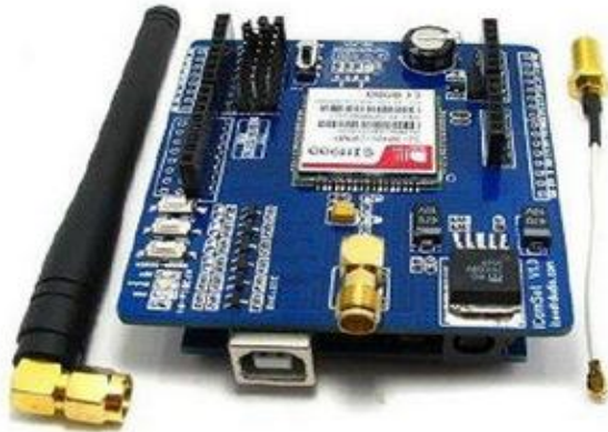
Figure 2-9: The GSM SIM900A module [28]
