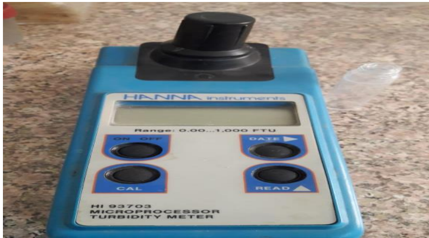
Fig (7): Turbidity meter
