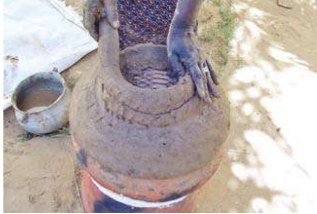
صورة رقم (21،4،3) توضح خطوات تصنيع الموقد
