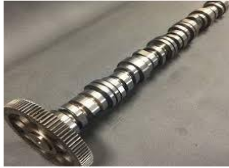
الشكل (6/3) أعلاه يبين عمود الكامات
