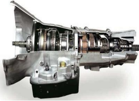
الشكل (11/3) أعلاه يبين صندوق التروس الأتوماتيكي
