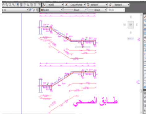
الشكل (19-4) الدرج في المسقط الإنشائي (واجهة AutoCAD)
