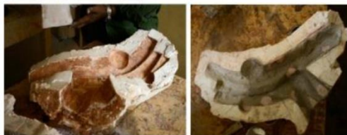
طريقة وضع الحواجز لصب القلب
