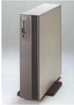
الشكل (3) جهاز NCR Tower 1632 [3] بمواصفات: 46 MB HDD, 512 K memory, 1 MB floppy [4].
