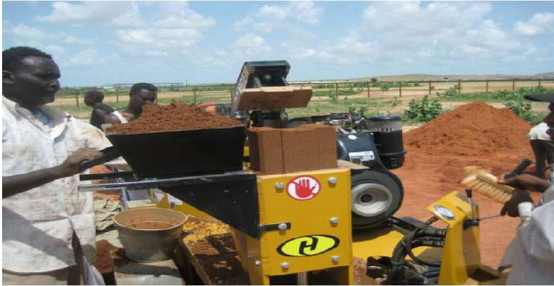
الشكل 3-4: استخدام المواد المحليه الرمل والطين المضغوط لانتاج الطوب.
