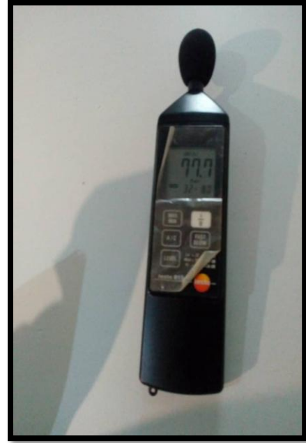
الشكل ( 5 - 1 ) يوضح جهاز قياس شدة الصوت (SOUND LEVEL MEETER)
