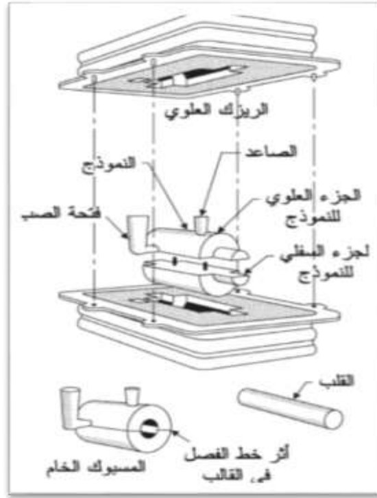
صورة (2-3) شكل قالب الصب من الداخل
