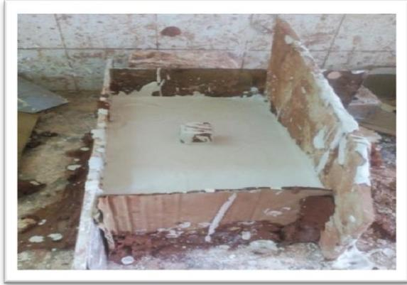
صورة رقم (6) قالب من الجبس لتوضيح طريقة النسخ
