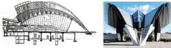
شكل(3-36) تقويس ورشاقة الأسلوب الإنشائي المنعكس على سقف الفراغ باستخدام الجمالونات في الإنشاء
