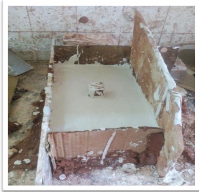
صورة رقم (6) قالب من الجبس لتوضيح طريقة النسخ
